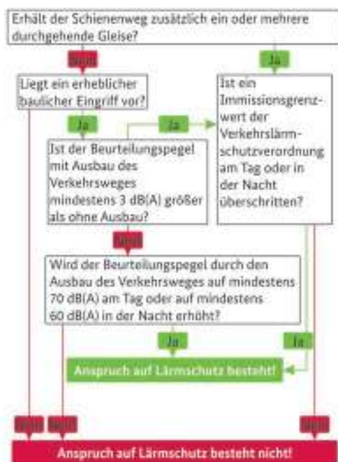
Abbildung 10: Ablaufschema zur Prüfung des Anspruchs auf Maßnahmen zum Lärmschutz im Rahmen der Lärmvorsorge.
