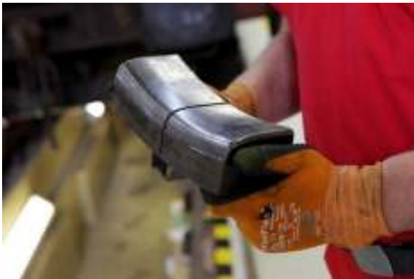
Abbildung 54: Beispiel einer LL-Bremssohle.
