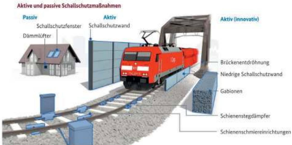
Abbildung 53: Im aktiven und passiven Schallschutz entwickelte und verwendete technische Lärminderungsmaßnahmen.
