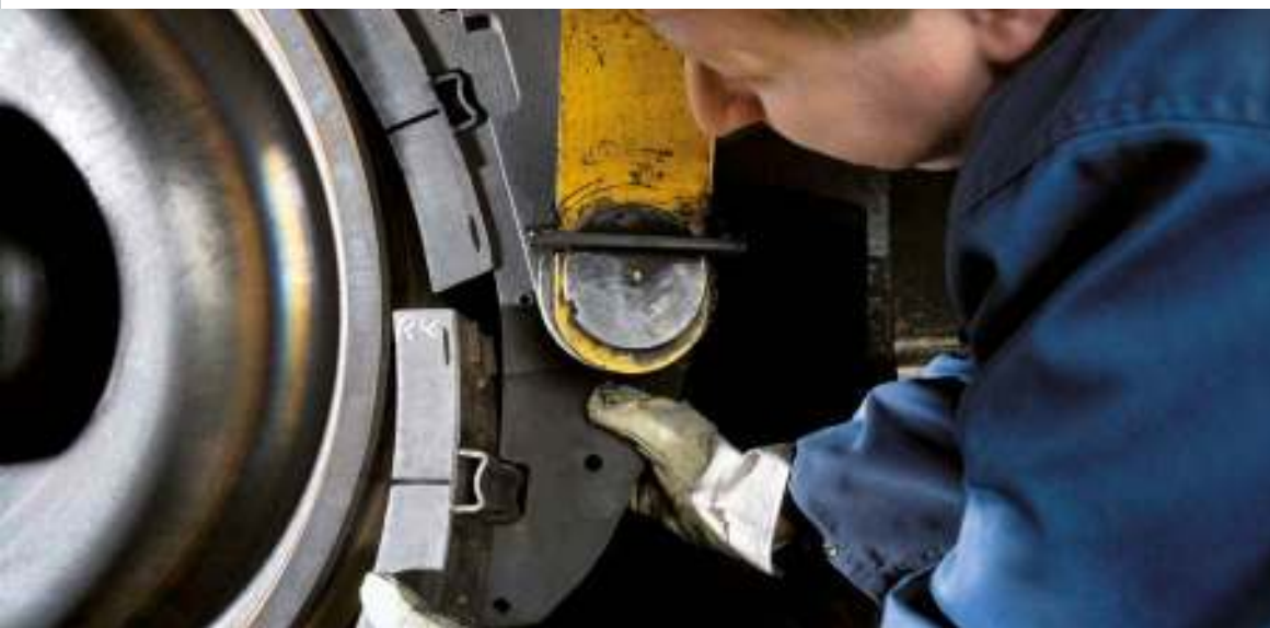
Einbau einer LL-Sohle bei einem Güterwagen.
