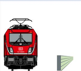
Unmittelbar am Gleis installierte **niedrige Lärmschutzwände** (nSSW) in Höhen von 55 beziehungsweise 74 Zentimetern: Diese eignen sich jedoch nur für eine Reduzierung von wenigen Dezibel, hohe Lärmschutzwände können sie keinesfalls gleichwertig ersetzen.
